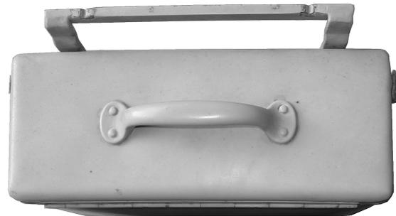
**Der Blechstreifengriff** war ein einfacher leicht hohl profilierter Blechstreifen der auf den Deckel der Packtasche ab Ende 1943 durch Schweißen befestigt wurde.
